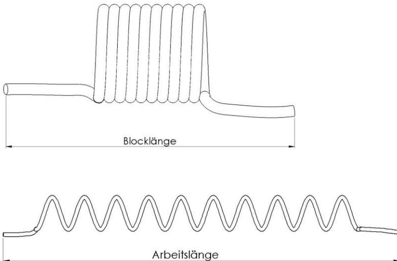
\*Die Arbeitslänge ist die maximal zulässige Streckung (Grenzwert). Nach überschreiten des Grenzwertes kann eine bleibende Verformung eintreten.
